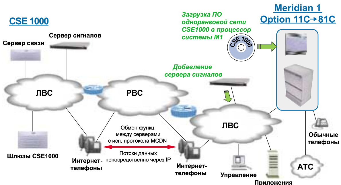
Одноранговая сеть с использованием систем Succession CSE и Meridian 1
